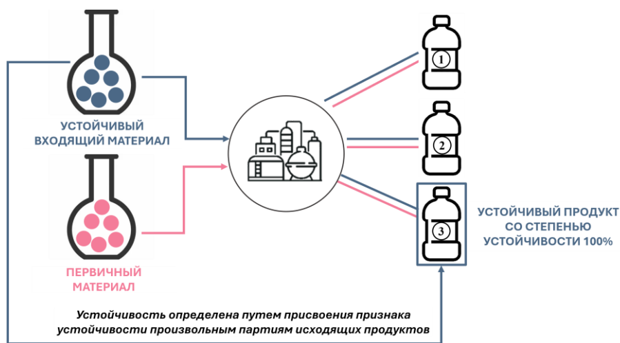
Рисунок 9. Определение устойчивой доли исходящих продуктов путем присвоения устойчивой доли в размере 100 % произвольной партии исходящих продуктов
